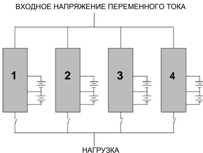
Рисунок 25 - Схема подключения изделий в систему параллельного резервирования
