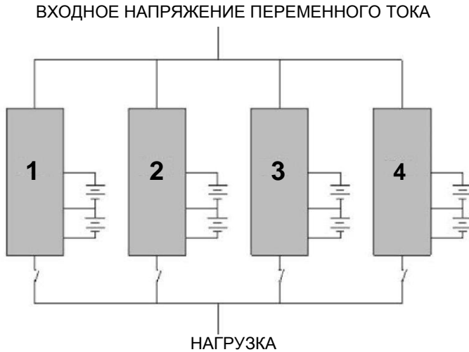
Рисунок 26 - Схема подключения изделий в систему параллельного резервирования
