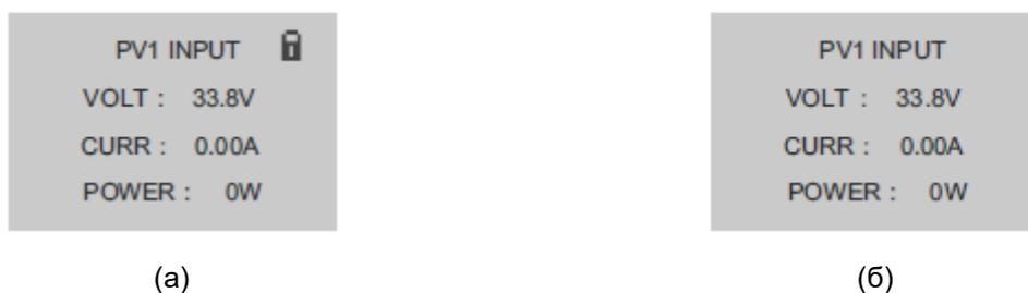
Рисунок 29. Блокировка и разблокировка ЖК-экрана инвертора
